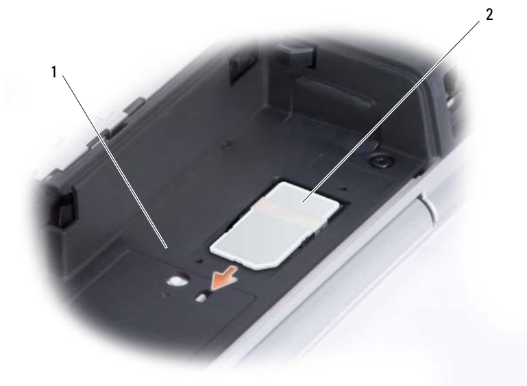
1 Compartimento de baterías 2 SIM
