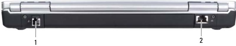
1 Conector de módem (RJ-11) 2 Conector de red (RJ-45)
